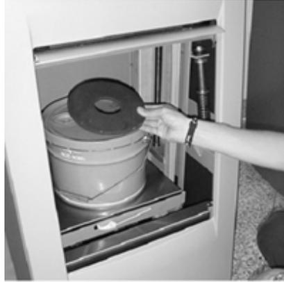
Placer un disque sur le couvercle afin d'éviter tout déplacement pendant le fonctionnement.
