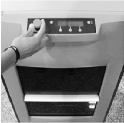
Tournez le bouton d'arrêt d'urgence dans le sens des aiguilles d'une montre pour le déverrouiller : l'écran affiche les actions de démarrage ainsi que le message « ready ».
