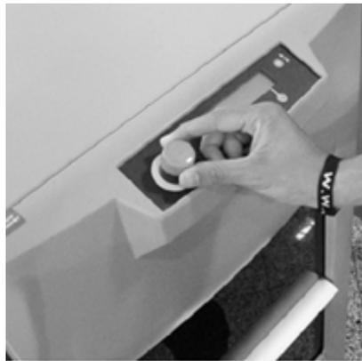
Vérifiez que le bouton d'arrêt d'urgence est déverrouillé (tourner dans le sens des aiguilles d'une montre).
