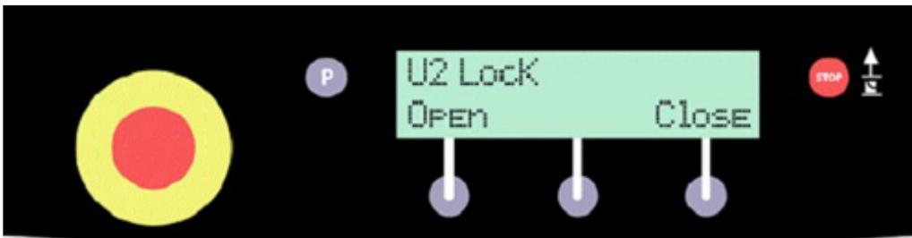
Die U2-Option wird zum manuellen Schließen oder Entriegeln der Tür benutzt. Dies könnte nach einem Stromausfall oder einem versehentlichen Schließen der Tür, während der Strom abgetrennt ist, erforderlich sein.
