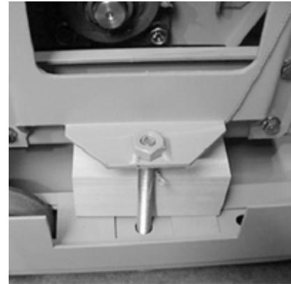
Den Karton und die Plastikfolie entfernen. An beiden Seiten der Maschine sind nun die Transportschutzschrauben zu sehen.
