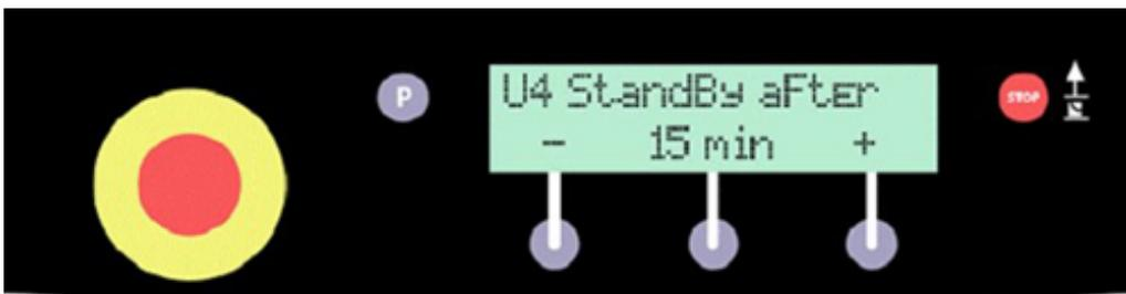
Die U4-Option dient der Festlegung des Zeitabstands, ehe die Maschine in den Standby-Modus geschaltet wird.
