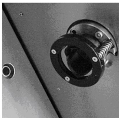
Fixer le perforateur électrique à l'aide des 3 écrous M6 fournis.
