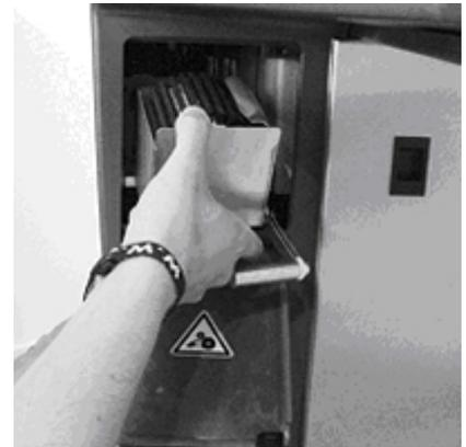
Replacer le réservoir de brosse dans son emplacement original. Le liquide de brosse doit être remplacé chaque jour !
