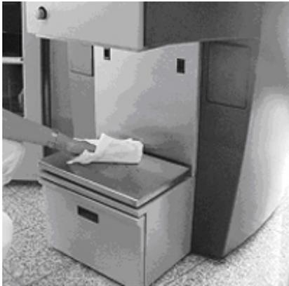
Nettoyez la table élévatrice et l'extérieur de la machine avec du produit nettoyant dilué.
