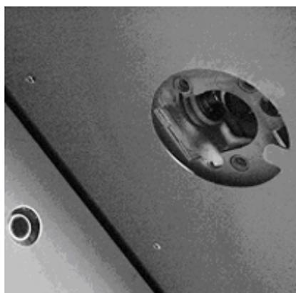
Les trois écrous pour fixer le perforateur électrique sont situés autour de la valve de dosage.
