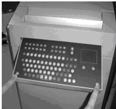
Appuyer sur les touches "Punch" pour faire monter la table élévatrice et pour perforer. \* Pour les modèles sans clavier intégré, utiliser les touches sur le bandeau avant.
