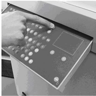
Appuyer sur la touche fléchée du clavier pour faire monter la table élévatrice. \* Pour les modèles sans clavier intégré, utiliser les touches sur le bandeau avant.
