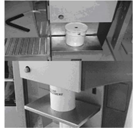
Positionner la poignée du perforateur en alignement avec l'axe du dosage puis placer le pot au centre de la table élévatrice.
