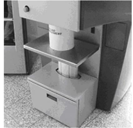
El movimiento hacia arriba se parará automáticamente. Esta es la altura óptima para la dosificación.
