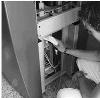
Limpie el polvo del espacio para el ordenador y el colorante derramado en el interior de la máquina.
