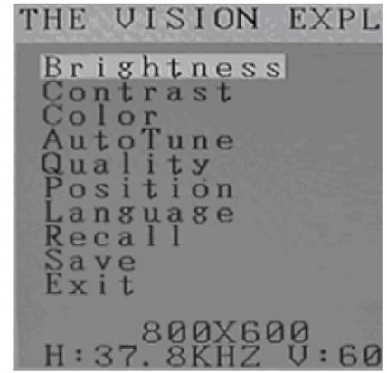
Ejecute la función "Autotune" (sintonización automática) y "Posición – Central". Guarde los ajustes al salir.
