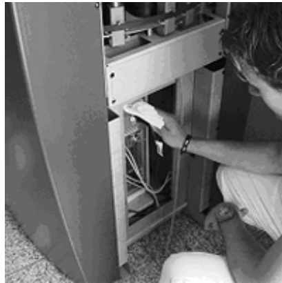
Fjern støv fra computer hulrum, og spildt tonepasta indeni maskinen.
